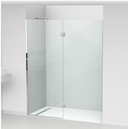
Panneau fixe en verre sécurit transparent 8 mm monté sur 2 profilés en aluminium poli brillant 20 x 16 x 20 mm. Porte pivotante montée sur 2 charnières BALNEUM en inox 316 L brossé fixées sur le panneau fixe. Tendeur à 45° en inox. Joints d'étanchéité en PVC translucide. Joint de seuil double lèvre avec lèche-goutte. Joint vertical côté charnières à bourrelet. Joint de fermeture à blocage. Visserie inox fournie.
